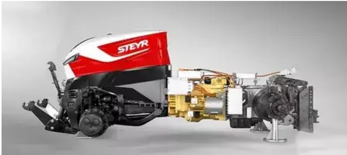
Bild 3: Steyr Hybrid CVT [4].
