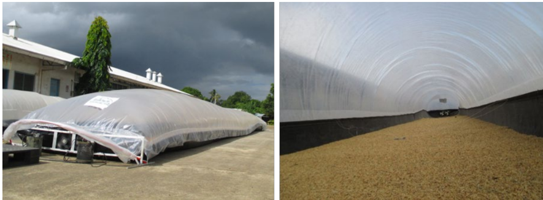
Bild 3: Traglufttunnel zur Trocknung von Reis in den Philippinen mit Blick auf die Ventilatoren am Trocknereingang (links) und Innenansicht mit Blick auf die Reisschicht (rechts) [9]
