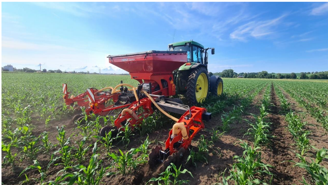
Bild 3: Bei der Tiefendepotdüngung mit dem Rauch DeePot wird in jeder zweiten Reihe ein Düngerbund abgelegt [5]
