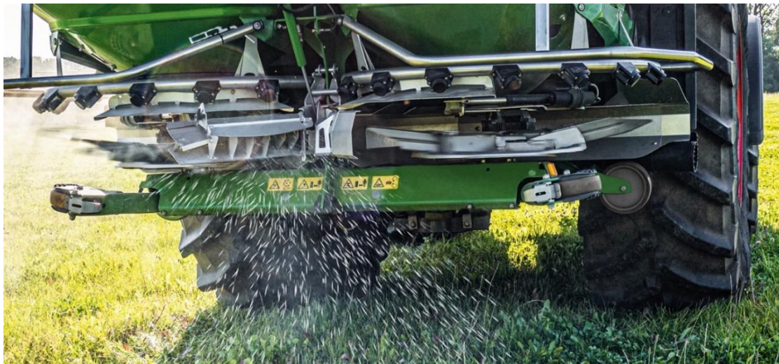
Bild 1: Der BorderTS-Schirm wird in den Streufächer eingeschwenkt und verhindert das Dünger über die Feldgrenze hinaus verteilt wird [3]
