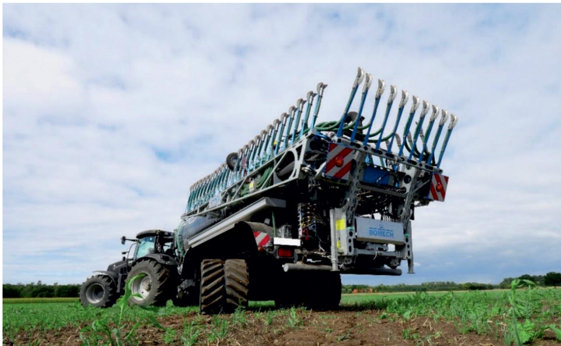
Bild 1: Smart Traction Fahrwerk mit aufgebautem Güllebehälter. [12]
