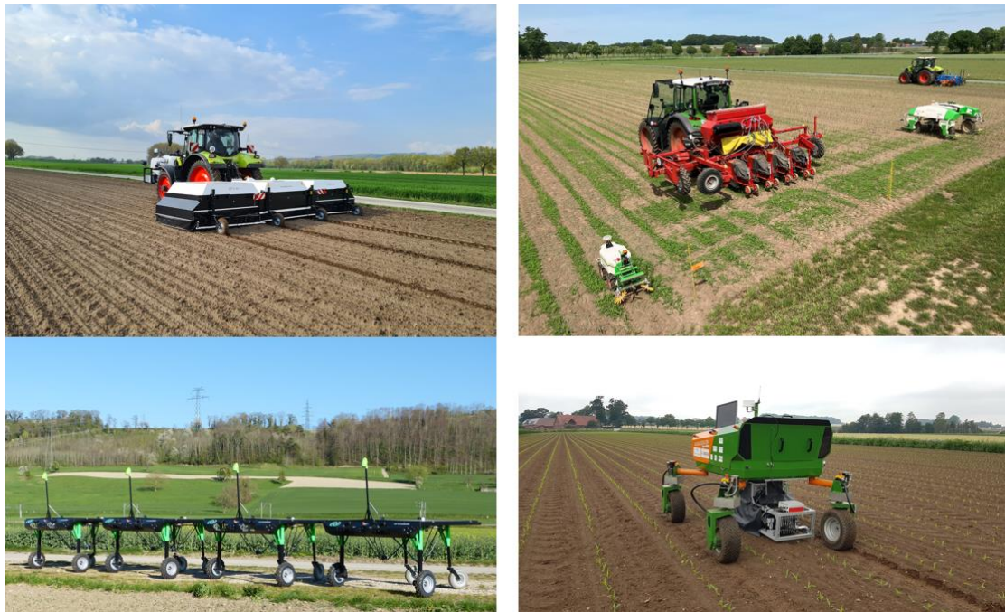
Bild 2: Feldroboterschwarm ecoRobotix (links unten), Anbaugerät ecoRobotix ARA (links oben); Feldroboter BoniRob mit MWLP-Weeder (rechts unten), Anbaugerät mit mehreren MWLP-Weeder-Modulen (rechts oben, rotes Anbaugerät in der Bildmitte); Bildquellen: ecoRobotix [30], AGRAVIS Holding GmbH [33], Hochschule Osnabrück, Dr. Wolfram Strothmann [32]
