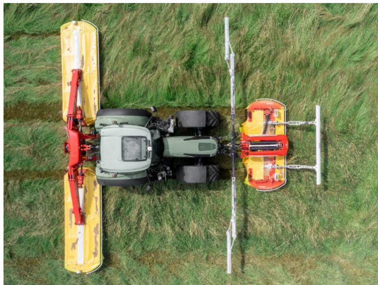
Bild 2: Sensosafe: Sensorbasiertes Assistenzsystem zur Tiererkennung von Pöttinger [6]
