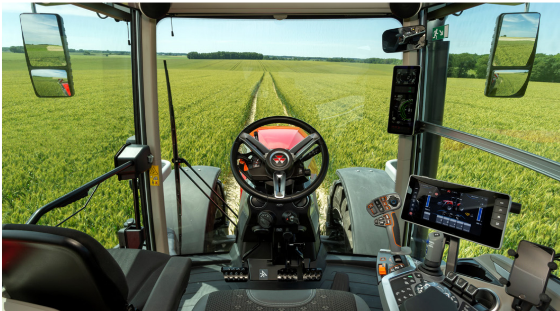
Bild 1: Massey Ferguson 8S als typischer Vertreter mit neuer Kabine ohne Armaturenbrett
