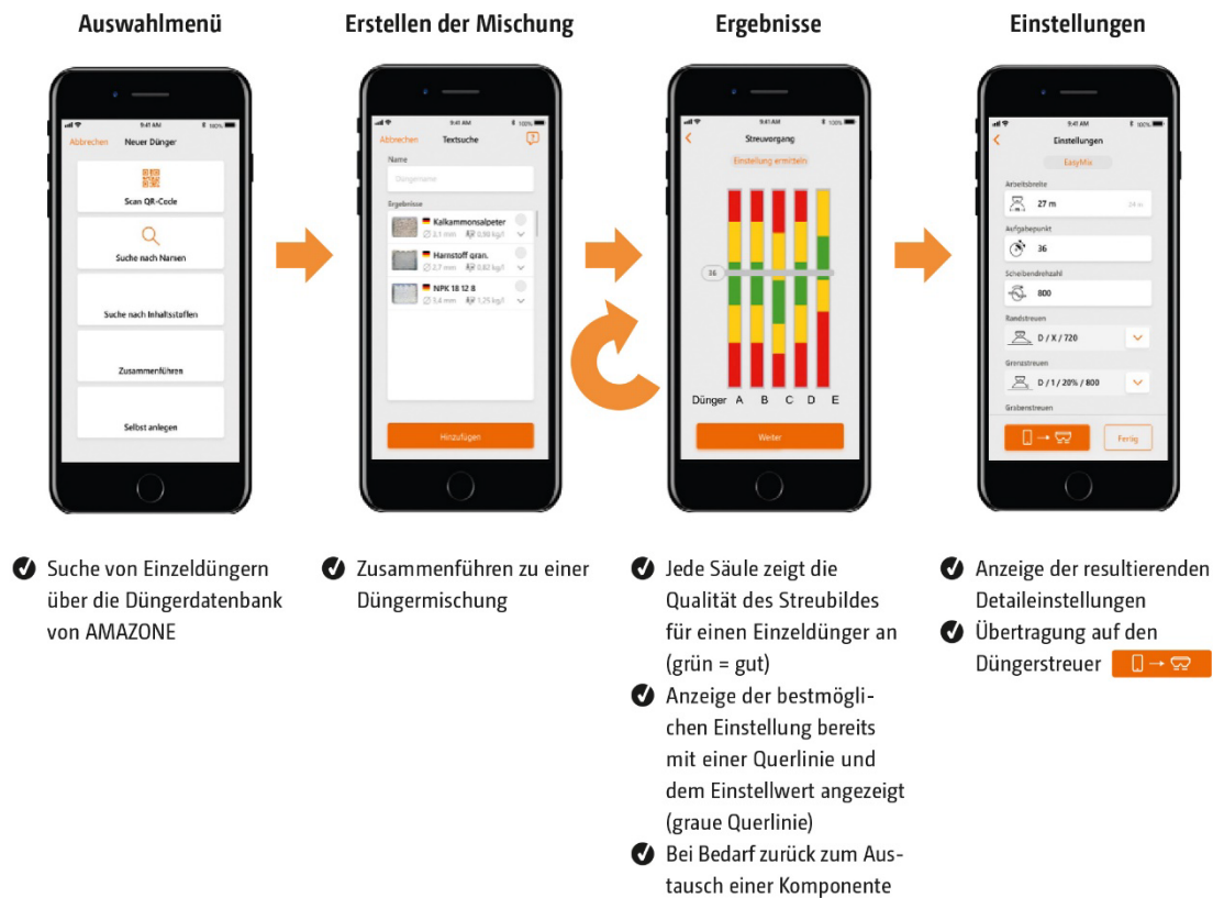
Bild 2: Mit der Amazone-App „EasyMix“ kann bereits vor dem Mischen von Einzeldüngern die Streufähigkeit des Mischdüngers beurteilt werden und sie hilft, beim Streuen von Mischdünger den Düngestreuer richtig einzustellen (Werkbild Amazone)
