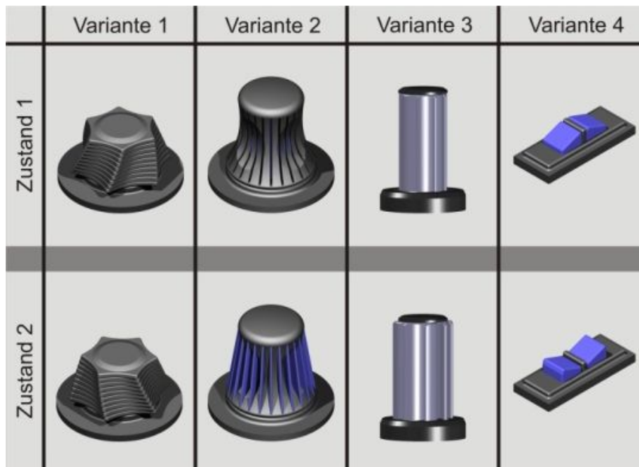
Bild 3: Konzeptvarianten von vier möglichen adaptiv variablen Stellelementen [79]
