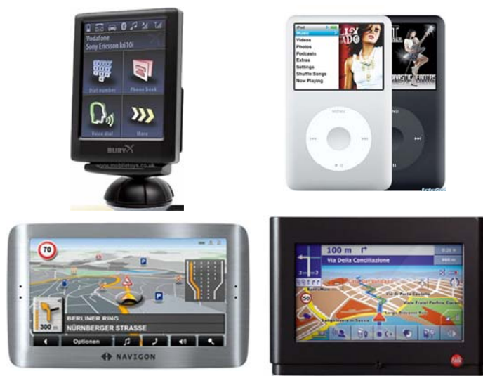
Abbildung 6: Darstellung der verwendeten IVIS. Links oben: Freisprechanlage Bury CC9060; rechts oben: handelsüblicher iPod; links unten: Navigon 8110; rechts unten: Falk N240L.
